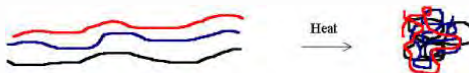
आकृति 3.14. गर्मी के उपयोग द्वारा प्लास्टिक पॉलिमर का रिकॉयलिंग
